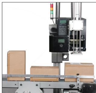
Etiquetage sur des objets mobiles de différentes tailles. Jusqu'à 30 étiquettes par minute.
